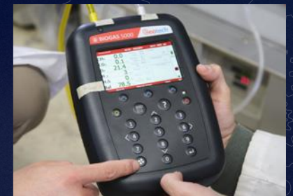
専用機器でメタンガスを測定
