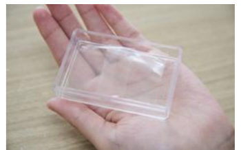
セルロースナノファイバーから作製したナノペーパー
